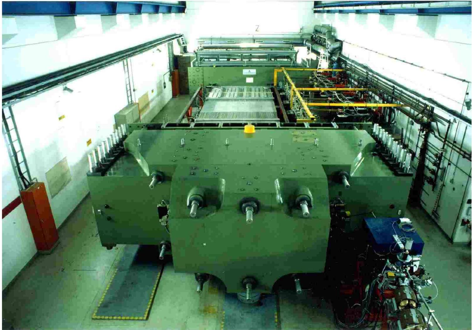
*Dritte Stufe von MAMI: Das weltweit größte Mikrotron. Das Gewicht der beiden Ulenkmagnete (grün) beträgt jeweils 450 Tonnen. Der Linearbeschleuniger (auf der rechten Seite) wird von den Elektronen 90 mal durchlaufen. Er besteht aus 5 Sektionen, die jeweils mit einer eigenen Hochfrequenzversorgung mit einer Leistung von 50 000 Watt ausgestattet sind.*
