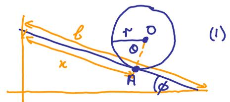
Für die Aufstellung von  $T$  wurde der Punkt  $O$  als Ursprung des körperfesten Koordinatensystems gewählt. Die Angabe  $T_{rot} =$  bezieht sich auf Rotation um die Rotationsachse  $O$ . Da dieser Punkt  $O$  sich selbst bewegt, ist zusätzlich ein Term  $T_{transl.} =$  erforderlich.
