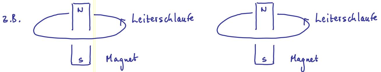
Elektromotorische Kraft in Leiterschleife ist dieselbe, unabhängig davon ob Leiterschleife ruht und Magnet bewegt wird oder umgekehrt.
