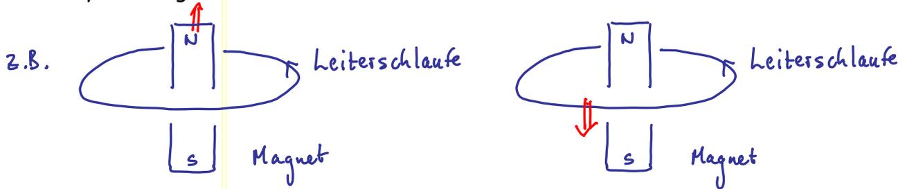
Elektromotorische Kraft in Leiterschleife ist dieselbe, unabhängig davon ob Leiterschleife ruht und Magnet bewegt wird oder umgekehrt.
