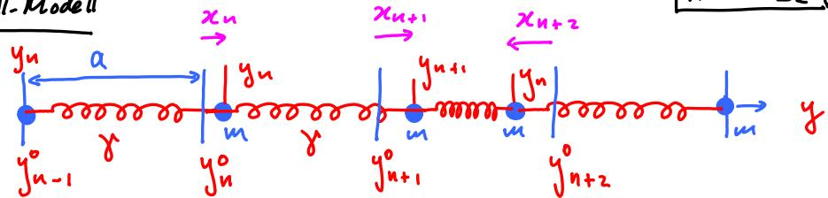
Gleichgewichtspositionen:  $y_n^0 = na$ ,  $n = 1, \dots, N$  Auslenkungen:  $x_n = y_n - y_n^0$  (1)
