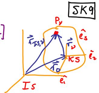
Kinetische Energie:  $2T = \sum_{v=1}^N m_v \vec{v}_{IS,v}^2 \quad (2)$
