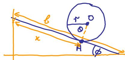
Für die Aufstellung von  $T$  wurde der Punkt O als Ursprung des körperfesten Koordinatensystems gewählt. Die Angabe  $T_{rot} = \dots$  bezieht sich auf Rotation um die Rotationsmomentachse O. Da dieser Punkt O sich selbst bewegt, ist zusätzlich ein Term  $T_{transl.} = \dots$  erforderlich.
